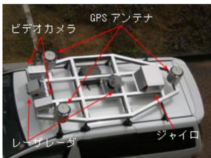
図-9 上部計測ユニットの構造
